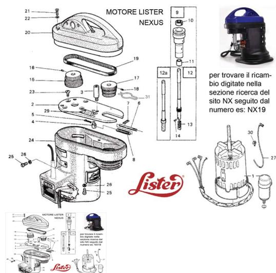
RICAMBIO LISTER NEXUS MOTORE 20V CON CONDENSATORE FIG.NX1
