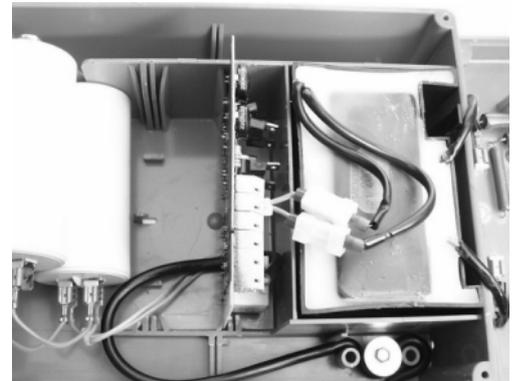
Per finire, legare i fili primari provenienti dal trasformatore con un collare di plastica collegandolo il più vicino possibile al morsetto terminali (**Foto A**).
