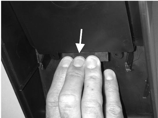
3) Inclinare i fermagli di plastica della parte inferiore del coperchio mantenendo la scheda in appoggio sui finecorsa (schema A)
