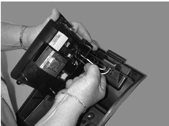
1) Collegare i fili dell'interruttore On/Off (a) sulla scheda (vedere schema di collegamento in alto)
