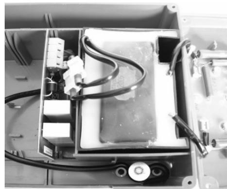
Per finire, legare i fili primari provenienti dal trasformatore con un collare di plastica collegandolo il più vicino possibile al morsetto terminali (**Foto A**).
