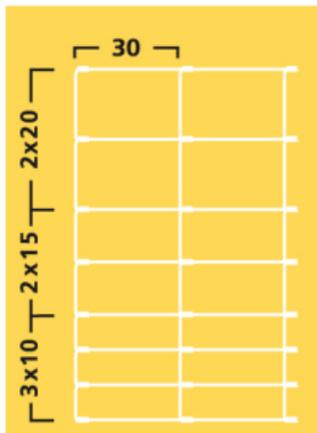
Rete annodata in bobina da mt.50 a maglia differenziata. I fili verticali lineari ed orizzontali sagomati della rete sono in acciaio zincato. L'impiego è rivolto alla recinzione di aree ad uso agricolo e zootecnico. Realizzata con 8 fili orizzontali con larghezza 30 cm. e con interasse come da immagine.
