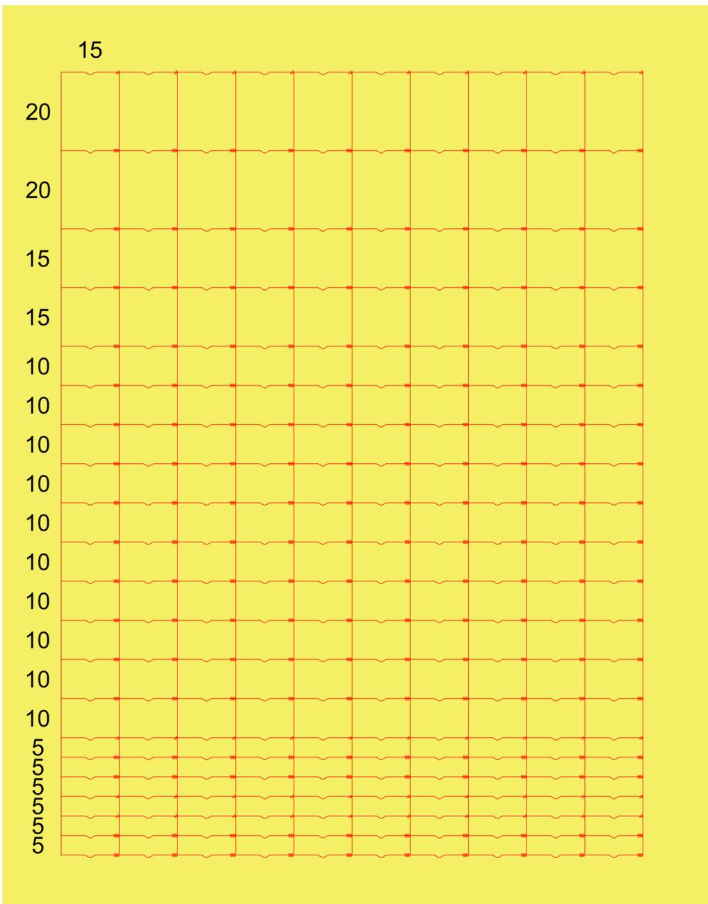
Rete annodata in bobina da mt.50 a maglia differenziata. I fili verticali lineari ed orizzontali sagomati della rete sono in acciaio zincato. L'impiego è rivolto alla recinzione di aree ad uso agricolo e zootecnico. Realizzata con 21 fili orizzontali con larghezza 15 cm. e con interasse come da immagine.
